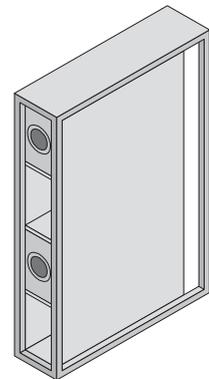
Serienmäßige Auslieferung des LCP 3311.540 (max. 30 kW) mit zwei Lüftermodulen.
