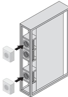
Zum Erreichen der max. Kühlleistung von 30 kW muss der Kunde/Service zwei zusätzliche Lüftermodule einbauen.
