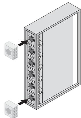
Zum Erreichen der max. Kühlleistung von 55 kW muss der Kunde/Service zwei zusätzliche Lüftermodule einbauen.
