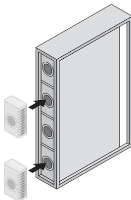
Zum Erreichen der max. Kühlleistung von 30 kW muss der Kunde/Service zwei zusätzliche Lüftermodule einbauen.
