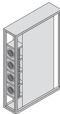
Serienmäßige Auslieferung des LCP 3311.260/.560 (max. 55 kW) mit vier Lüftermodulen.
